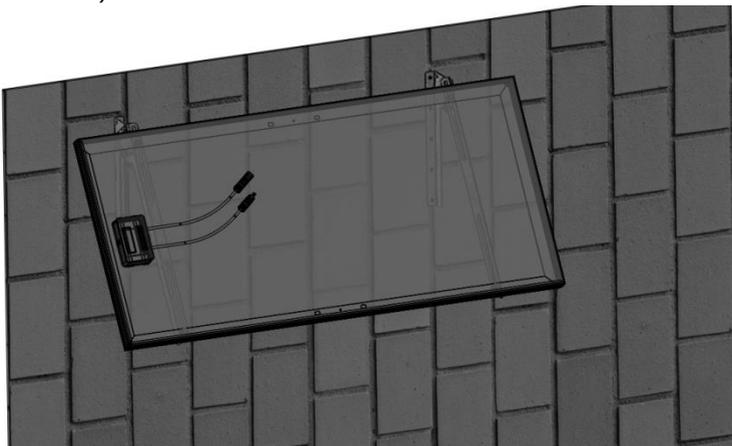
Simple à installer, Unifix 145 B se fixe sur une surface plane rigide à l'horizontale ou à la verticale (ex: mur, sol béton, ossature bois).
