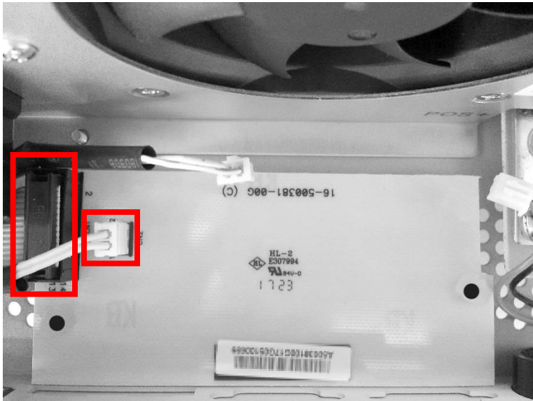
Figure 5 : Retirer les connecteurs du panneau de contrôle beige.
