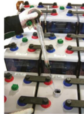
Fig. 6-2 : Aéromètre
