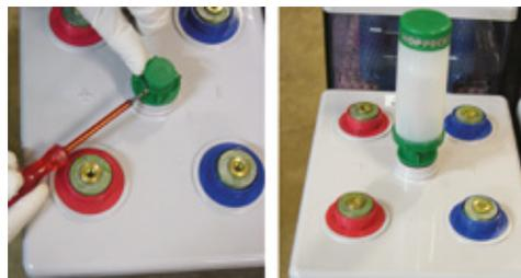
Fig. 5-14 : Bouchon-labyrinthe (à gauche) et système de recombinaison AquaGen® premium.top (à droite)
