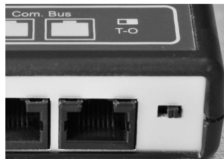
Terminaison BSP désactivée (position O)
