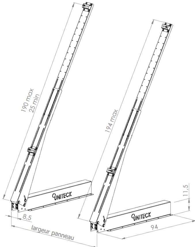
Simple à installer, les supports Unifix 600 B se fixent sur une surface plane rigide à l'horizontale ou à la verticale (ex : mur, sol, ossature bois).
