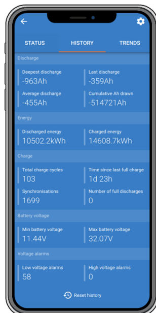
Écran de l'historique du contrôleur de batterie dans l'application VictronConnect.
